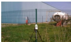
Photographie d'un sonomètre en cours de mesurage
